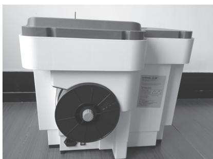
4. Faites passer le bout du filament à travers l'ouverture spécifique et faites-le glisser jusqu'à ce qu'il sorte du tube de guidage à l'intérieur de l'imprimante.
