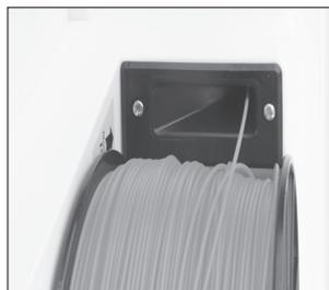
5. Faites passer le bout du filament dans l'ouverture de l'extrudeuse de la tête d'impression.
