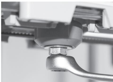
Chauffez la buse restante à température de fonctionnement, via le menu **Paramètres → Filament L/UL → Chargement**. Au bout de quelques minutes, une fois que la tête d'impression est chaude, le filament s'écoule par l'ouverture. Terminez le processus au bout de 20 à 30 secondes. Retirez le morceau de filament qui sort de l'ouverture à l'aide d'une pincette, en tirant vers le bas.
